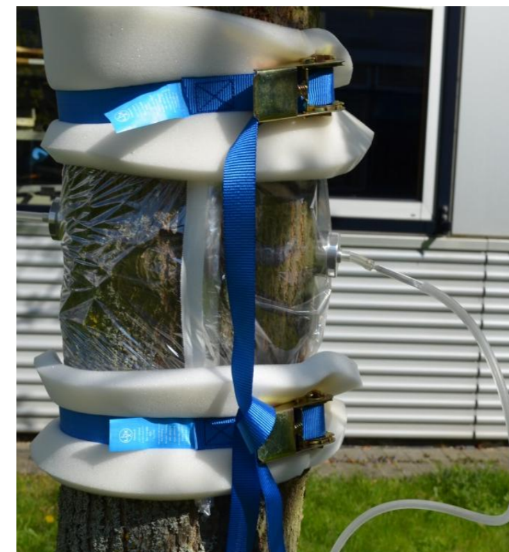
Links: Aufbau zur Anreicherung der Geruchsspur des Baums auf Geruchsfiltern; rechts: Chromatogramm der Geruchsspur
